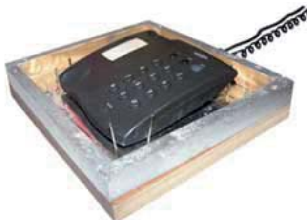
Bild 6. Apparaten fixerades i läge med spikar i hörnen.
