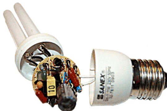
"Lågenergilamporna" innehåller bl.a. elektronik
